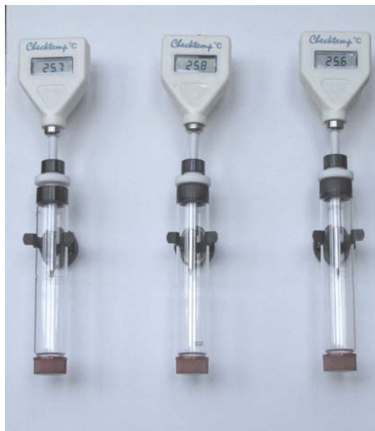
Einfache Experimentieranordnung zur Untersuchung der Wärmeabsorption unterschiedlicher Gase (Luft, Methan, CO 2 )
