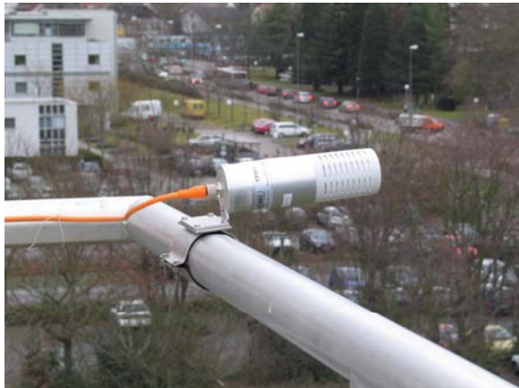
Vaisala sensor GMP 343 auf dem Gebäude INF 561. Position: 44°25' 13.17N 8°40' 10.71O Höhe: 110m über NN; Gebäudehöhe: 18m
