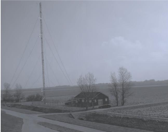
CO<sub>2</sub> Messstation der Universität Groningen, Niederlande; Messungen in verschiedener Höhe der Atmosphäre
